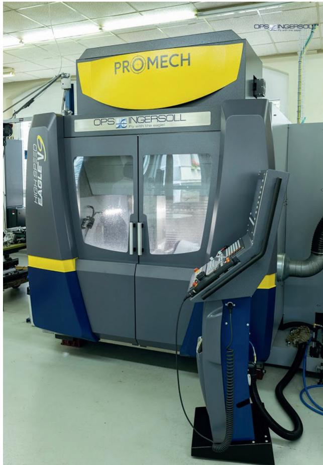
4 Die High-Speed Eagle V9 von OPS-Ingersoll: präzise bei hochdynamischer Bearbeitung und universell einsetzbar; dafür sorgt das Gesamtkonzept aus Kinematik, Steuerung, Zugänglichkeit, Automatisierbarkeit und Spindel
