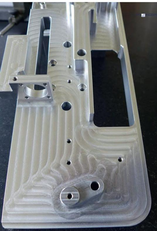
**3** Von diesen Bauteilen werden Fertigungszyklen von 500 bis 600 Stück pro Jahr abgerufen. Hierbei sind Form- und Lagetoleranzen von 0,02 mm gefordert
